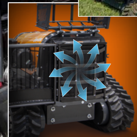
FLEXXAIRE® - SAMOCZYSZCZĄCY WENTYLATOR FREXXAIRE® SELF-CLEANING REVERSIBLE FAN
